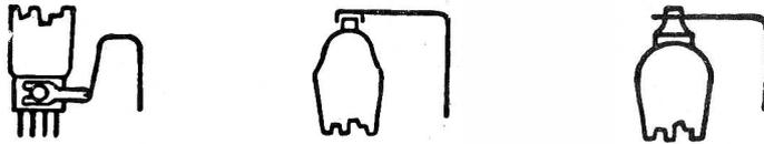
so bedeutet dies, daß die Röhre außenliegende Elektroden, wie Seitenklemme oder Anodenkappe besitzt, diese sind dann mit einem der vorhandenen Verbindungsstücke an die betreffende Buchse anzuschließen.
